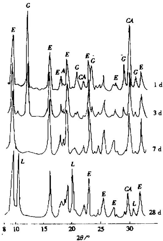
E: 钙矾石 G: 二水石膏 A: 铝胶 CA: 铝酸-钙 L: 单硫型水化硫铝酸钙
