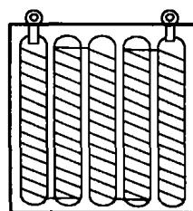
图 4 热流计测头平面示意图
