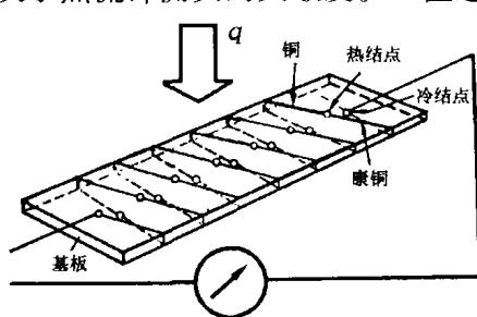
图 3 热流计测头
