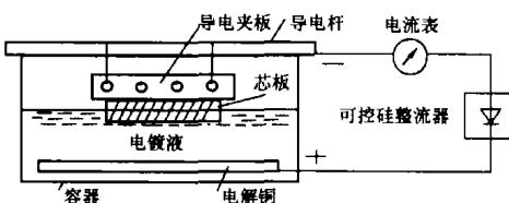
图 5 电镀装置示意图
