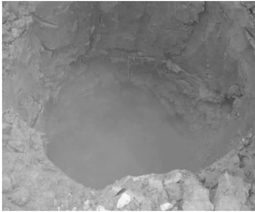
图7 土基爆炸后的空腔示意图
