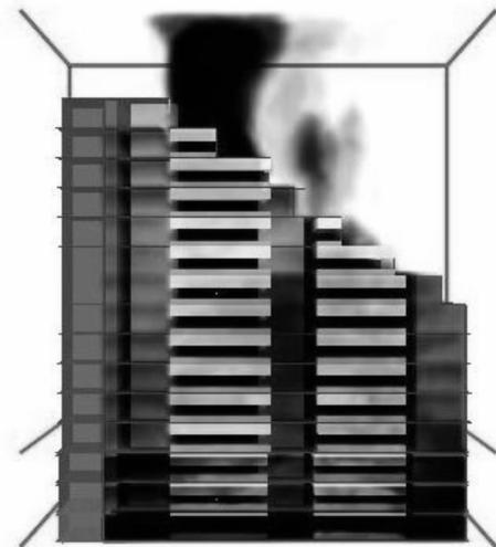
图 6 增加挡烟垂壁后 5 层 I 号火源烟气蔓延情况
