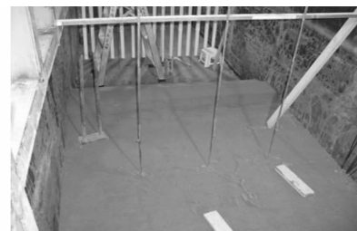
图3 模型中多点位移计埋设
