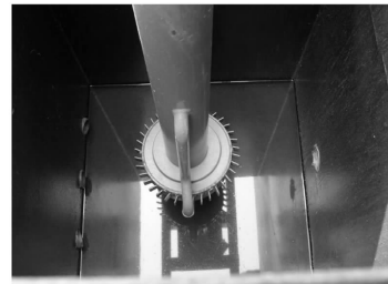
图 3 改进后的涡凹曝气机照片
