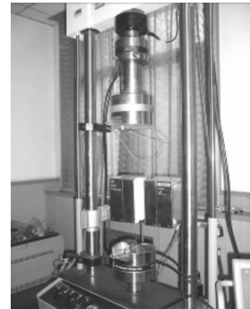
图1 MTS810电液伺服材料试验系统与MTS652.02高温环境炉
