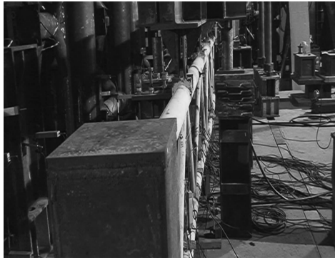
图 8 试验桁架极限荷载下的变形
