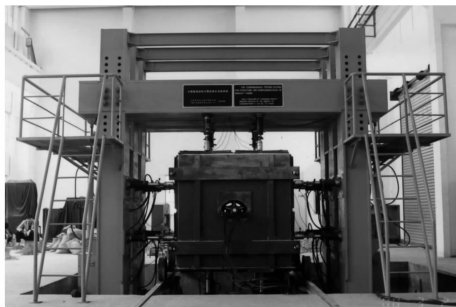
图 1 公路隧道结构与围岩综合实验系统
