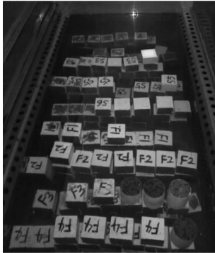
图 1 氯盐浸泡试验
