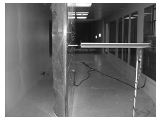
图 3 两端固结于五分量天平装置的节段模型
