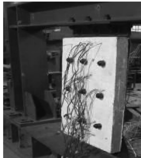
图 7 CDBF-A 深梁破坏模式
