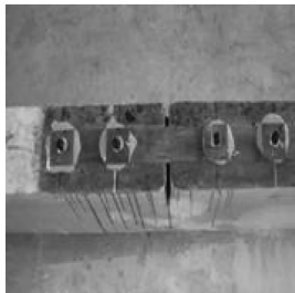
图5 HB-FRP 试件完成图
