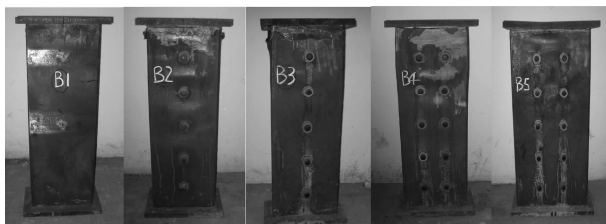
图3 试件的破坏形态
