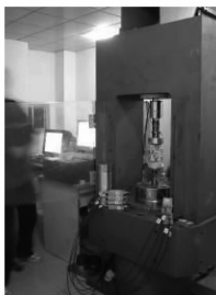
C) 微机控制电液伺服压力试验机
