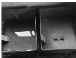
图9 电渗脉冲下试验箱底部水分排出
