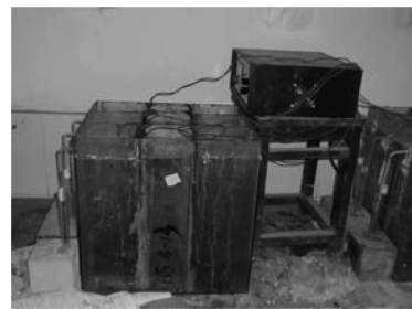
图1 混凝土渗水试验装置
