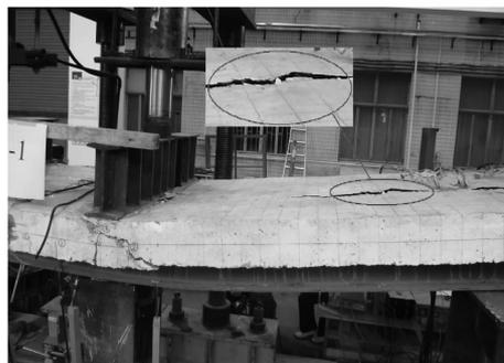
(b) 混凝土翼板裂缝和局部混凝土隆起
