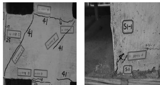
(a) 1.233 m处连梁斜向贯通裂缝 (b) 筒体角部混凝土压碎
