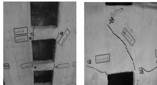
(a) 1.233 m以下连梁端竖向裂缝 (b) 1.233 m处连梁斜向裂缝
