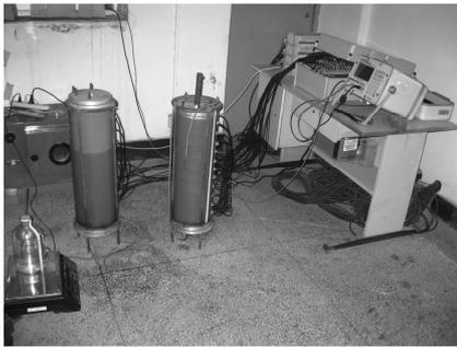
图2 等温条件下土体水分迁移测试系统实体图
