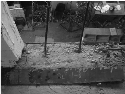
图 7 2 层圈梁③轴附近粘钢的破坏形态
