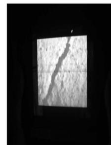
图4 梁柱交界处最先出现裂缝 图5 裂缝宽度达0.2 mm
