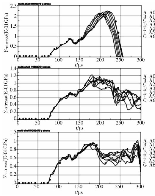
图5 不同H时模型中测点的应力时程曲线
