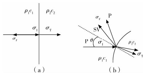
图 1 平面应力波在界面上的反射与透射
