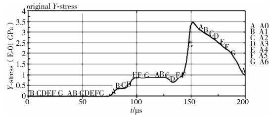
图4 原始模型中测点的应力时程曲线
