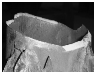
图 9 试件Ⅲ-A 加载至 1/150 时核心钢管断裂图
