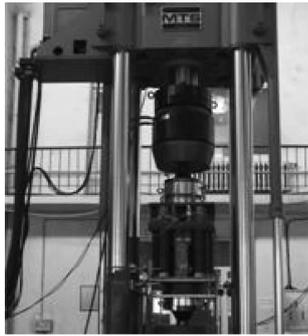
图 6 三维隔震装置竖向压缩试验
