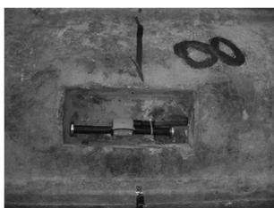
图 3 预制槽内放置应变计
