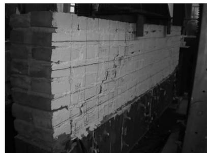
图3 试件 QL1 砌体裂缝
