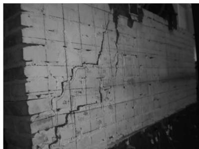
图 9 试件 QL5 砌体裂缝
