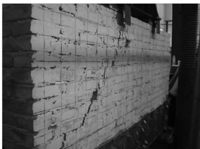
图 6 试件 QL2 砌体裂缝
