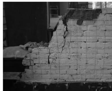
图 12 试件 QL5 墙体破坏
