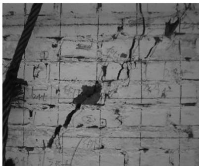
图 11 墙体压碎剥落破坏
