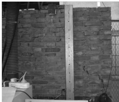
图 7 试件 QL3 砌体裂缝
