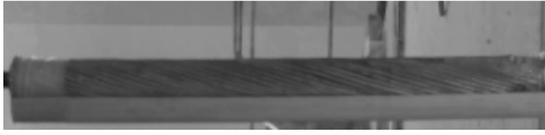
图 4 新月形覆冰导线试验模型
