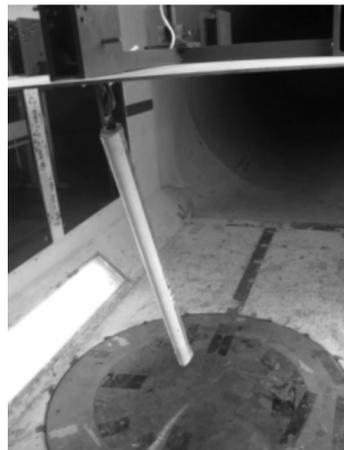
图 3 斜风下覆冰导线的试验模型
