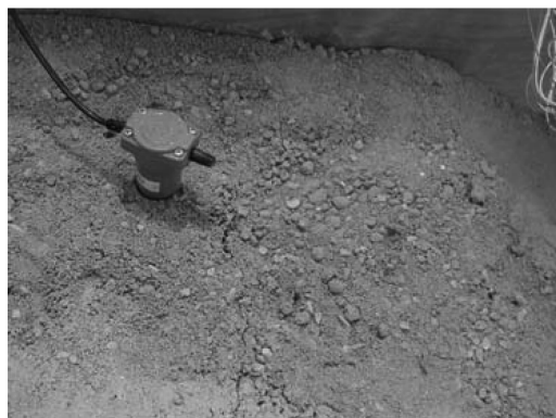
图 5 无开挖斜坡地震条件下坡顶裂隙分布照片
