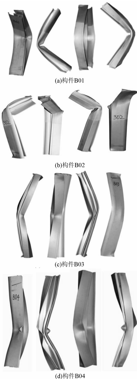
图 6 试验构件 B01~B04 试验后变形图
