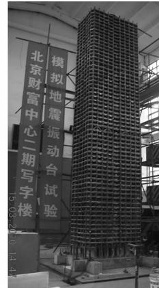
图 10 模型整体结构全景
