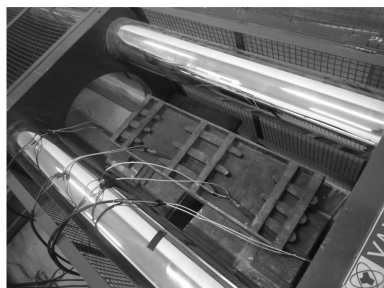
图 2 盒式弯起器的就位与钢绞线的布置情况 (Box10, R=600 mm)
