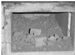
图3 600 °C作用后爆裂试件
