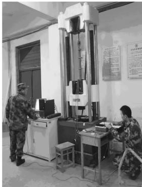
图6 拉拔力测试全图
