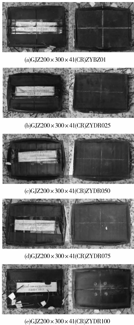
图 6 氯丁橡胶支座破坏形态
