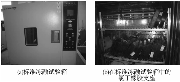
图 2 氯丁橡胶支座冻融循环处理情况
