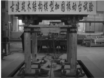
图9 CFRP加固古建筑木结构
