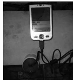
图 3 构件表面裂缝宽度测定
