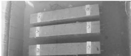
图4 置于浸泡池中的自锚梁
