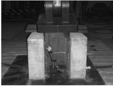
图2 推出试验加载装置
