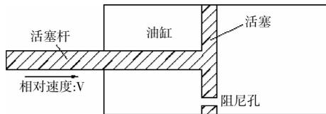
图1 液压阻尼器原理图
