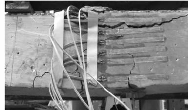
图 2 梁破坏状态
