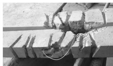
图 3 梁开槽后的形貌
