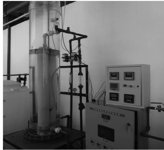
图 1 浸没式连续微滤工艺流程及装置图
