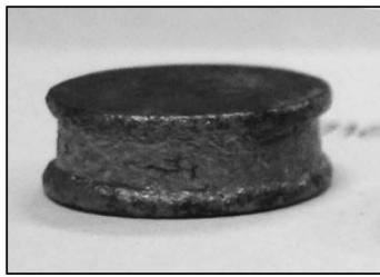
图 3 压缩变形后试样的两端鼓肚现象
