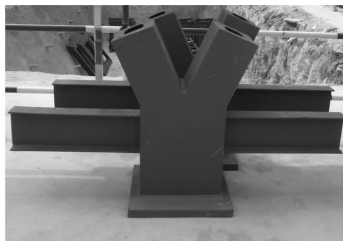
图 2 转换层节点试件实际照片
