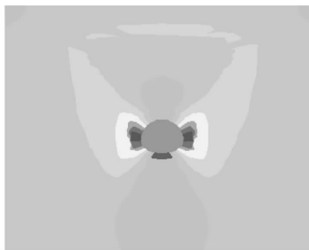
图 3 无支护隧道塑性区分布图
