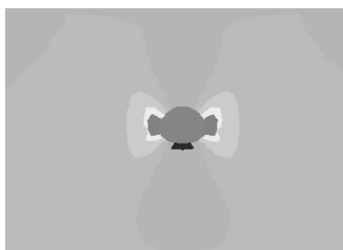
图 4 喷锚支护隧道塑性区分布图
