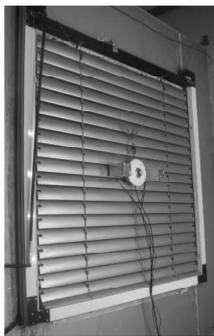
图 3 3 mm 透明玻璃与遮阳金属百叶帘组合体
