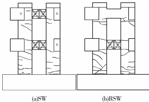
图 12 低周反复荷载试验结束后 SW 和 RSW 裂缝图
