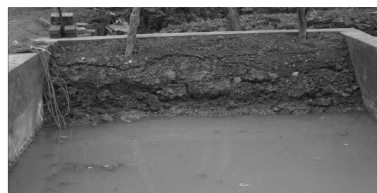
图 12 试验水位上升至 170 cm 岸坡模型
