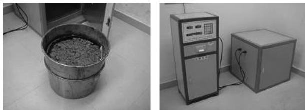
图 1 混凝土绝热温升测定仪
