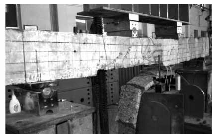
图 7 A 组未设 U 型箍试件的典型破坏模式(A-L)
