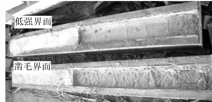
图 2 A 组待修补保护层的梁试件
