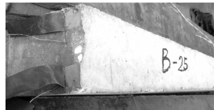
图 3 硬化后待粘贴 CFRP 的 B 组试件
