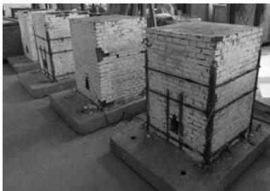
图1 4个震损墙筒模型
