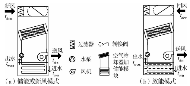
图 1 基站用相变储能机组模型示意图
